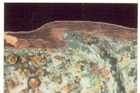
Abb. 13: Pfropfenentzinkung eines Messing-Ventilgehäuses. Detail aus Abb. 12
