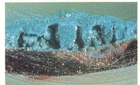
Abb. 5: Schnitt durch eine Lochfraßstelle
