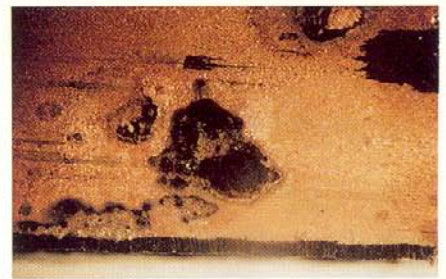
Abb. 3: Muldenfraß auf der Rohroberfläche eines Trafoölkühlers. Rohroberfläche geätzt. Kühlmittel: Flußwasser. Werkstoff: CuNi10Fe1Mn.
