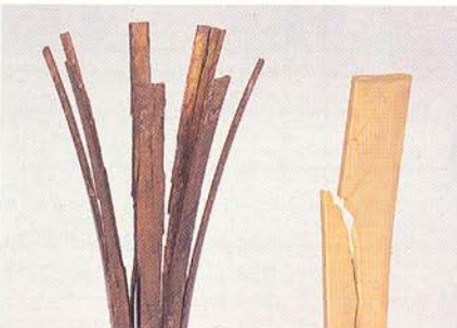
Abb. 14: Spannungsrißkorrosion. Nachweis von Zugspannungen an CuZn37 mit der Quecksilbernitratprobe
