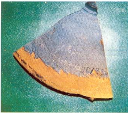
Abb. 20: Erosionskorrosion am äußeren Durchmesserbereich eines Pumpenlaufrades (Ausschnitt) aus G-CuSn10
