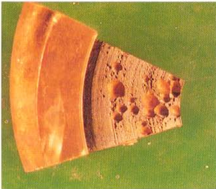
Abb. 21: Erosionskorrosion am Pumpengehäuse einer Kreiselpumpe (Ausschnitt). Werkstoff: G-CuSn10
